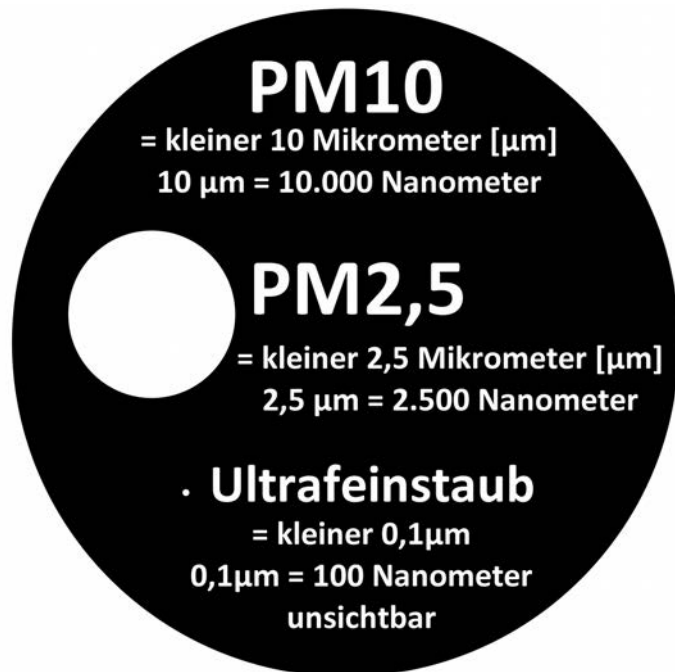
Abbildung 1: Diese Darstellung zeigt die Größenverhältnisse der Staubklassen.
